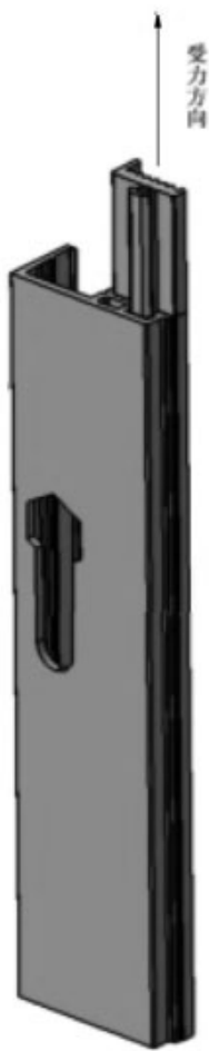
图 B.1 橡胶件与型材拔出力示意图
